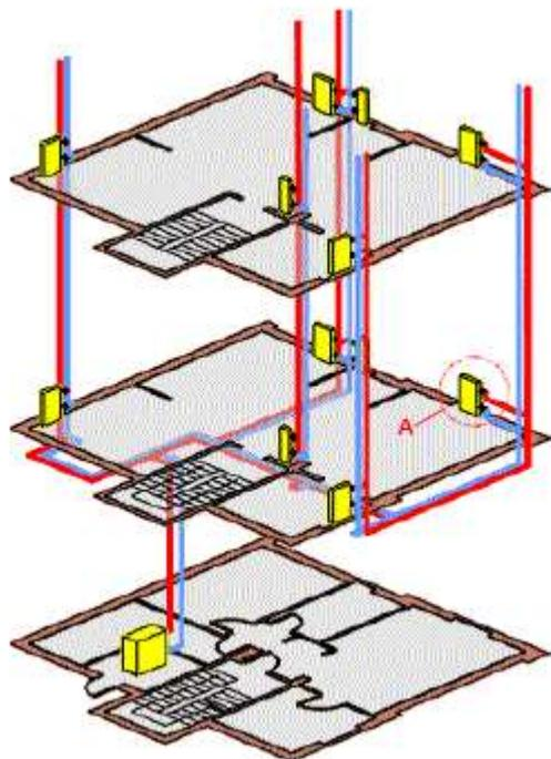
*Particolare del collegamento del corpo scaldante alla colonna montante.*
